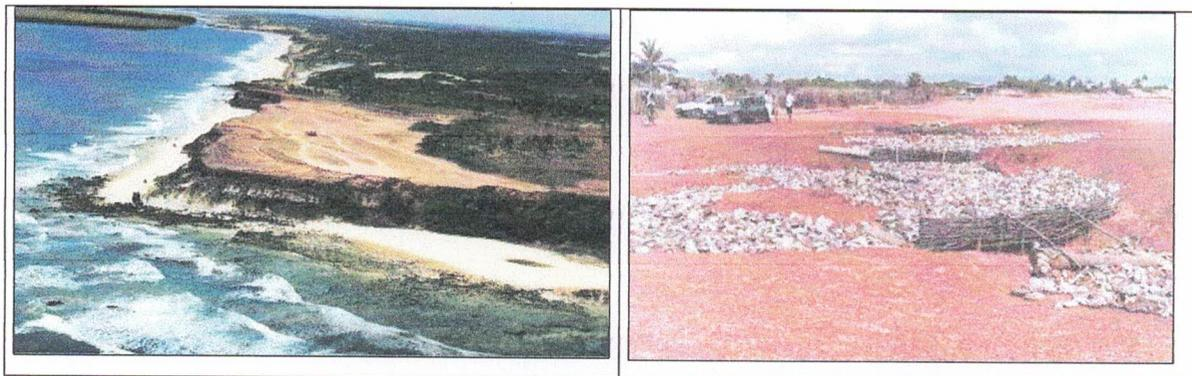
**Fig. 27 e 28.** Fotos do Chapadão de Pipa. A primeira apresenta uma vista geral e na segunda, à direita, a cerca delimitadora de hotel em construção. Em primeiro plano a tentativa de contenção da erosão com a colocação de cascas de coco retidas da ação do escoamento das águas superficiais com anteparo de madeira.
